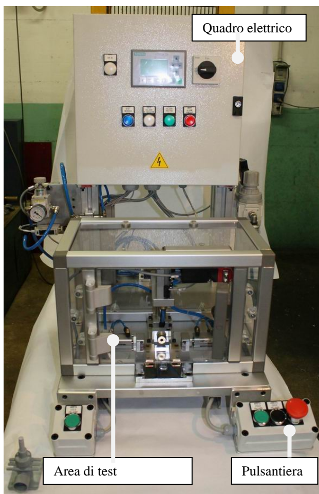
Figura Lista componenti principali del Banco Collaudo Valvola
